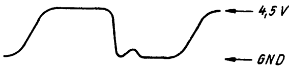
Bild 3 Systeminterrupt durch CTC, D116 Pin 11
